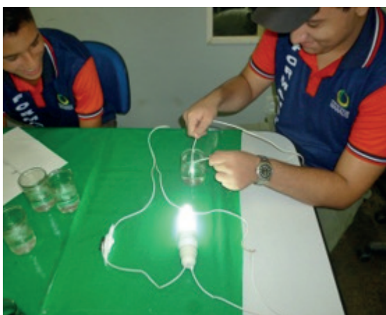
Figura 3. Teste positivo para de condutividade
